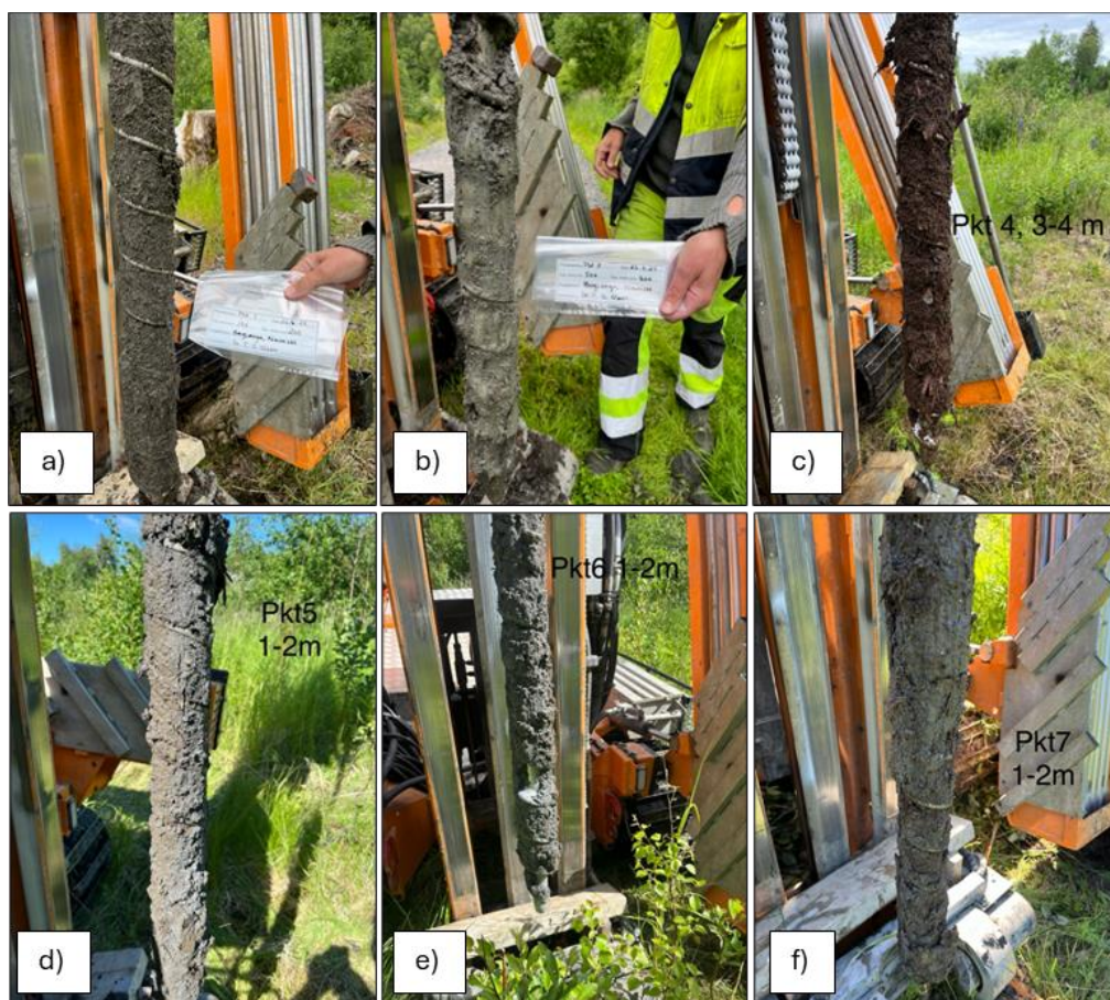
> Figur 7. Utvalgte bilder fra miljøteknisk grunnprøvetaking (ved boring) i juni 2024. a) prøvepunkt P1 i sjikt 1-2 m, b) prøvepunkt P3 i sjikt 5-6 m, c) prøvepunkt P4 i sjikt 3-4 m, d) prøvepunkt P5 i sjikt 1-2 m, e) prøvepunkt P6 i sjikt 1-2 m og f) prøvepunkt P7 i sjikt 1-2 m.
