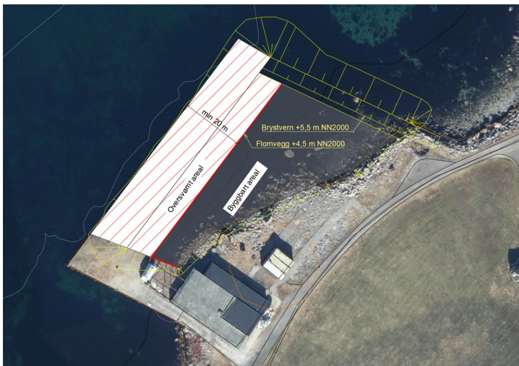
Figur 21 Alternativ sikring av ny fylling ved næringsarealet mot effekten av bølger og stormflo uten molo 3. Figuren tar ikke hensyn til at terrenget rundt og eksisterende kai oversvømmes.
