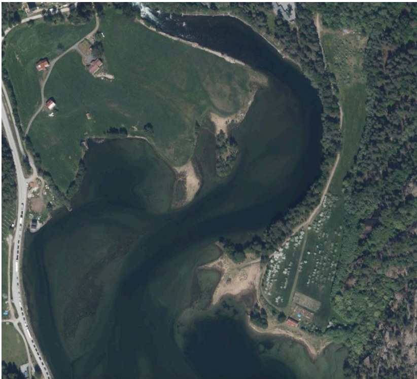
Figur 10. Flyfoto over Nagløyri frå 2021. Henta frå https://www.norgebilder.no . Merk utfyllinga i indre delar av bukta på vestsida av elveutløpet. Det kan også sjå ut som om det har vorte teke ut ein god del lausmassar frå gruntnvannsmiljøa på austsida av elveutløpet.
