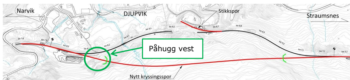
Figur 2: Planlagt nytt kryssingsspor i tunnel
