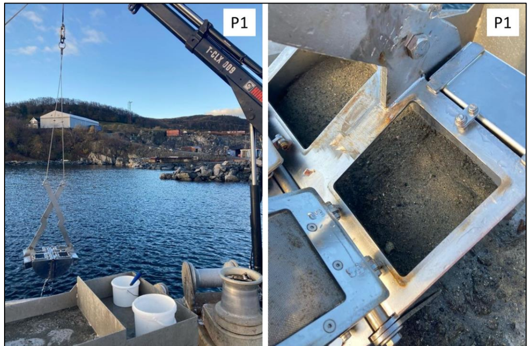
Figur 6: Stasjonen P1. Lite sediment i området. Bildet t.h. viser grå sand i grabb.
